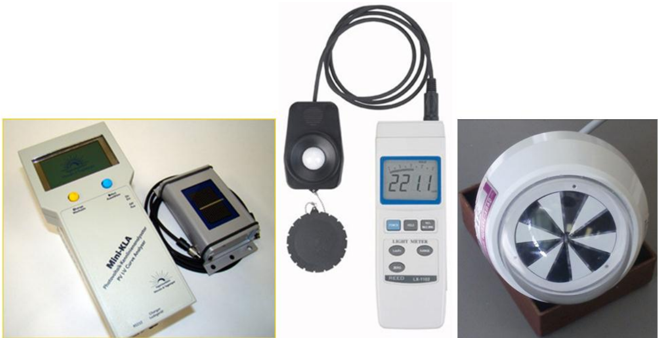
Obrázek 4: Zleva – Solární analyzátor s možností měření intenzity osvětlení, luxmetr, čidlo pyranometru
